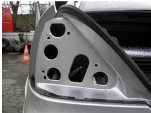
Die neue Leuchte mit dem Kabelbaum verbinden, Blackbox durch die große Öffnung (wo auch der Kabelbaum durch läuft) ins Fahrzeuginnere legen und mit dem Doppeltape befestigen.
