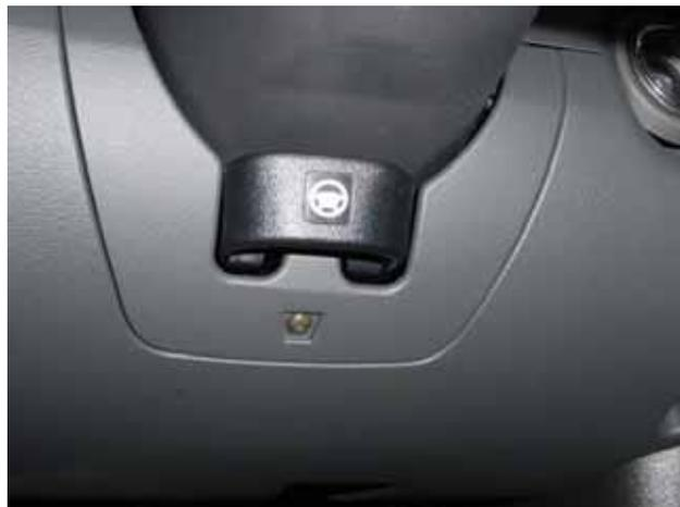
Die nun sichtbaren Schrauben, sowie die gekennzeichneten Schrauben entfernen
