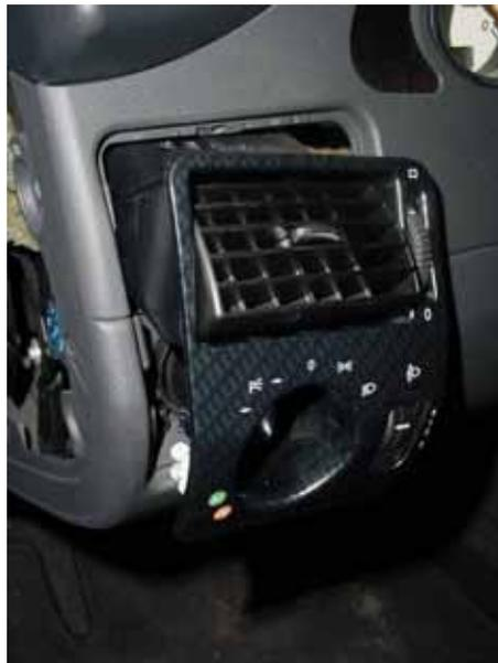
Danach die Schraube der kleinen Verkleidung unterhalb des Lenkrads entfernen
