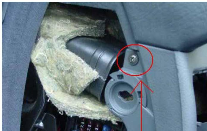
Die kleine Abdeckung an der Seitenverkleidung im Fahrerfußraum entfernen und die dahinter liegende Torx oder Kreuzschlitzschraube entfernen
