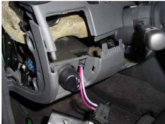
Die 3 Schrauben des Lichtschalters lösen (2 vorne, eine von unten), dann kommt man besser an die Stecker.
