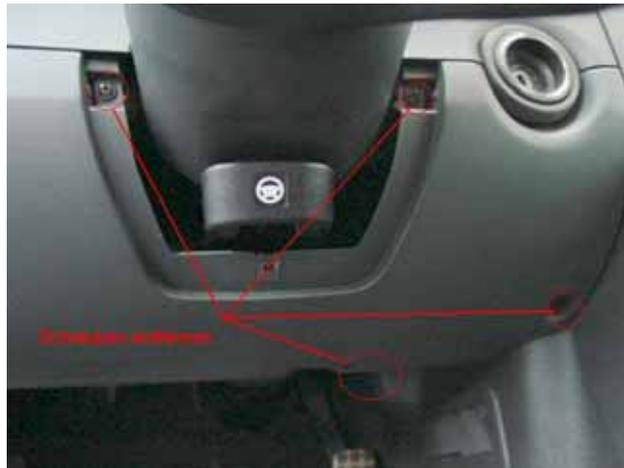
Die Schraube im Sicherungsbereich entfernen
