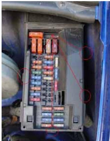
Den Sicherungskasteneinsatz entnehmen. Der ist eingeklipst.
