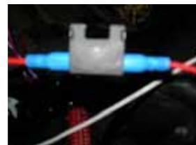
Vom Relais Kontakt 87a nun die Kabel durch die Tülle des Sicherungskastens nach vorne hinter die Stoßstange ziehen. Kabel mit Kabelbindern sichern.
