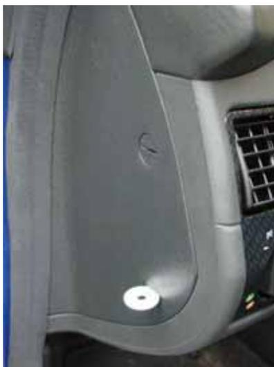
Die linke Luftdusche demontieren. Dafür die Lüftung nach oben drehen und die Schraube entfernen
