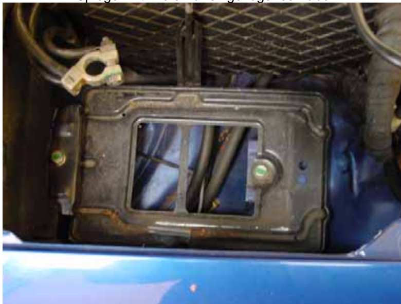
Batterie und die Trägerplatte der Batterie demontieren, dann kommt der Kabelbaum zum Vorschein.....
