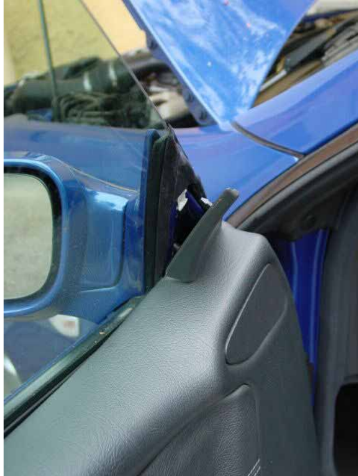
Das Dreieck durch nach Innen ziehen lösen. Achtung! Das weiße Plättchen geht gerne flöten... Kommt beim Abnehmen der Verkleidung wieder zum Vorschein ;-)
