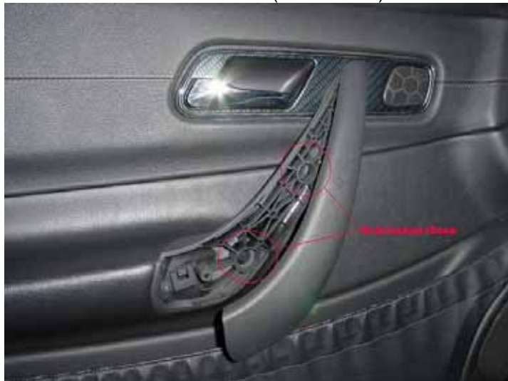
Dann die Schrauben lösen und die Verkleidung abnehmen (Clipse)
