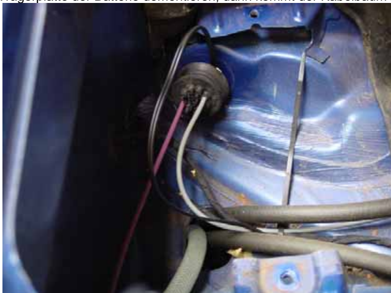
Batterie und die Trägerplatte der Batterie demontieren, dann kommt der Kabelbaum zum Vorschein.....
