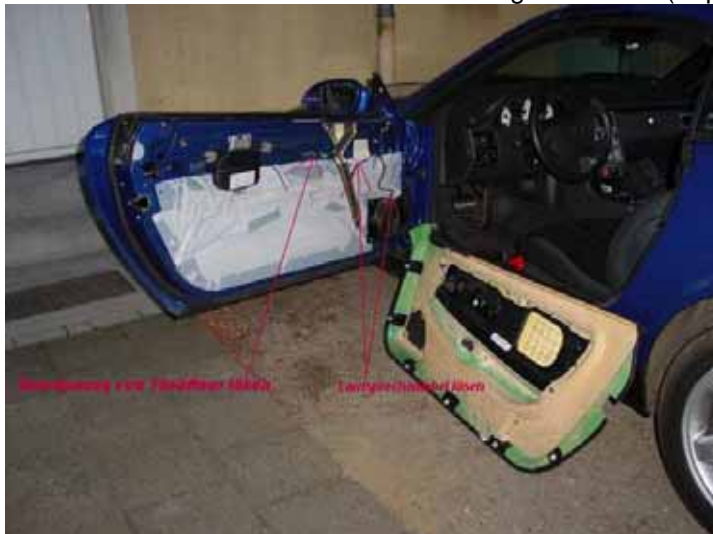
Beim Abnehmen der Verkleidung den Bowdenzug von der Türöffnung lösen, Lautsprecherkabel lösen, Später das Kabel vom Mitteltöner lösen und Mitteltöner demontieren
