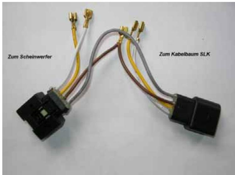
Nun die Kabel nach folgender Belegung in dem Sockel befestigen
