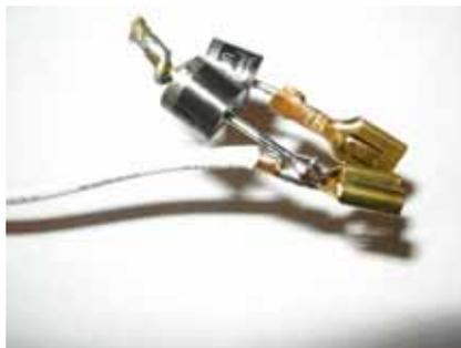
Das abgeknappte Kabel von 87 abisolieren, Schrumpfschlauch überziehen und an den Dioden anlöten. Mit dem Schrumpfschlauch isolieren.
