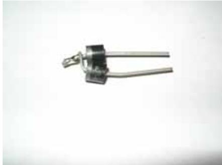
Das weiße Kabel an Klemme 87 abknipsen und eine Diode anlöten
