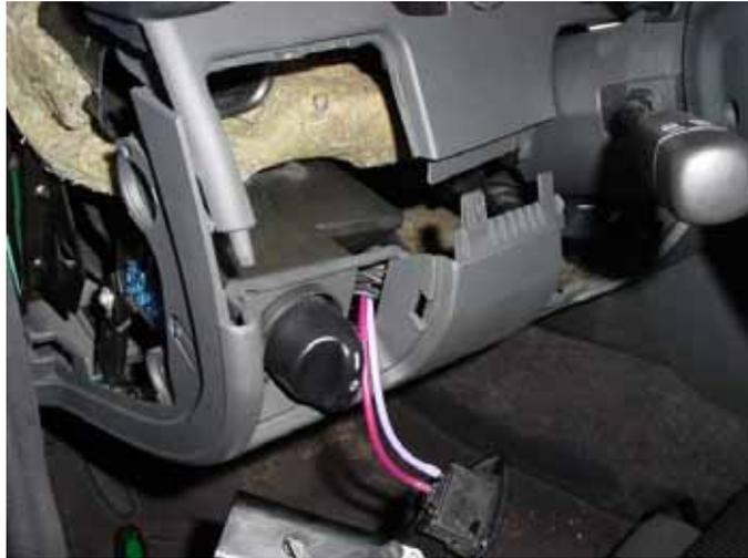
Jetzt sieht man auch die Steckverbindung zum Blinkerschalter
