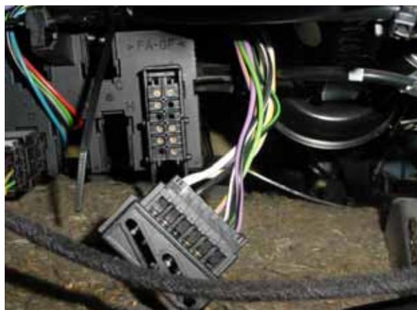
Nun das Modul zwischen den nun getrennten Kabelbaum setzen und das Massekabel in den Fußraum zum Massepunkt ziehen
