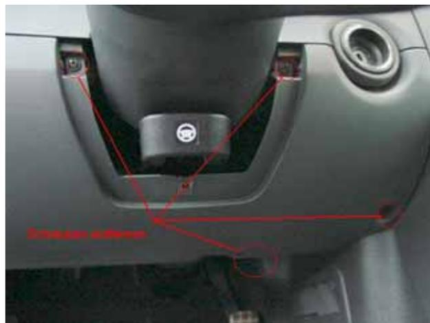
Die Schraube im Sicherungsbereich entfernen
