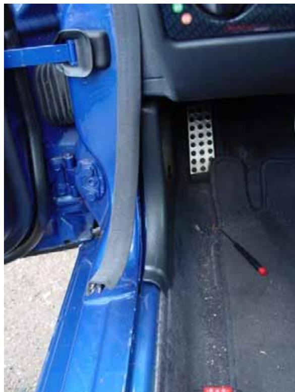
Im Fußraum die Pedalabdeckung mit 2 Kreuzschlitzschrauben lösen und entnehmen.
