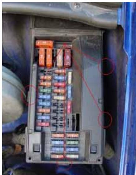
Den Sicherungskasteneinsatz entnehmen. Der ist eingeklipst. Man kann ihn einfach mit einem dicken Schraubendreher ausgehebelt werden.
