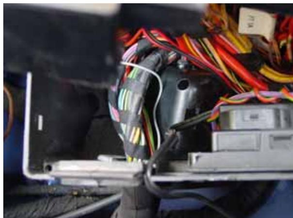
Die kleine Abdeckung an der Seitenverkleidung im Fahrerfußraum entfernen und die dahinter liegende Torx oder Kreuzschlitzschraube entfernen
