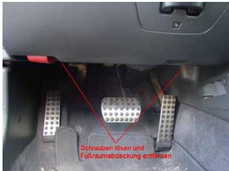
Dann die Kabel durch die Öffnung zum Sicherungskasten in den Fußraum ziehen.
