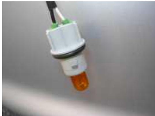
Leuchtmittel in die Fassung einsetzen und die neue Schiene einclippen
