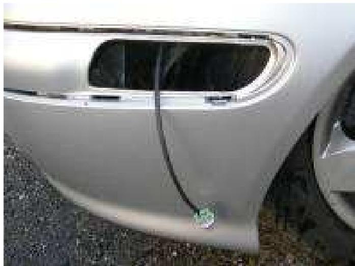
Das Kabel dann an das Standlicht anschließen.
