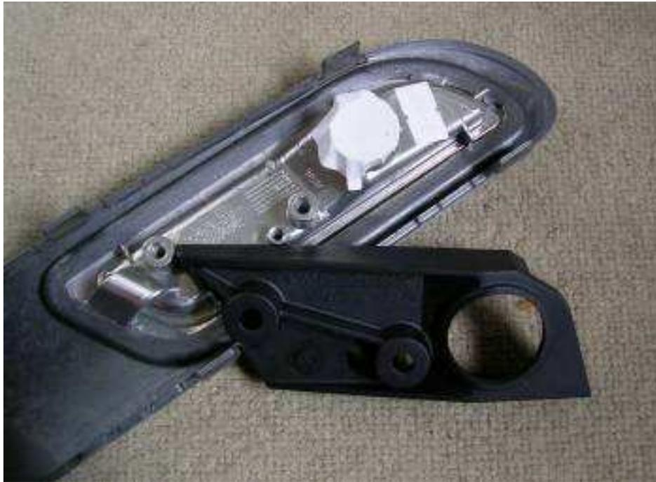
Den Halter mit zwei Schrauben festschrauben. Dadurch zieht sich die Leuchte ganz an die Schiene ran und die Schiene wird ganz gerade.
