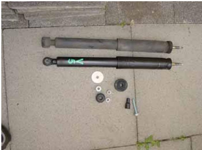
Den neuen Dämpfer mit dem Gummidämpfer aus dem Reparaturkit versehen und den Dämpfer einsetzen.
