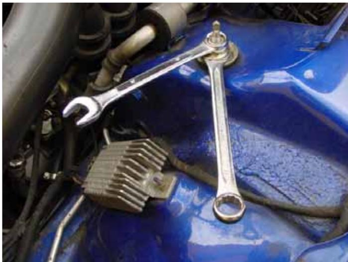
Die zweite Mutter mit dem Gabelschlüssel lösen
