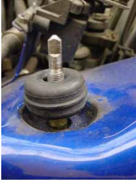
Den neuen Gummidämpfer einsetzen,
