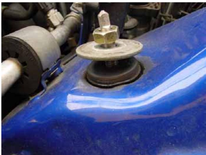
Muttern, U-Scheibe und Gummi entfernen (werden ersetzt)
