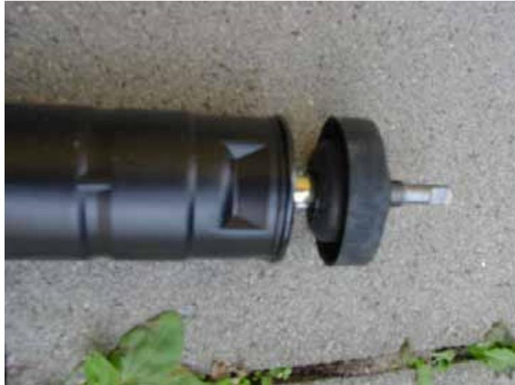
Dämpfer, mit der NEUEN selbstsichernden Schraube und Mutter wieder einsetzen. Die Mutter mit 55nM festziehen
